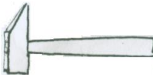
Martillo común: Herramienta con la cual producir el golpe necesario para la introducción del clavo en la madera
